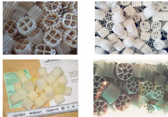
Figura 10.2 Diferentes tipos de soporte para reactor de lecho móvil. Orantes & González (2001)
