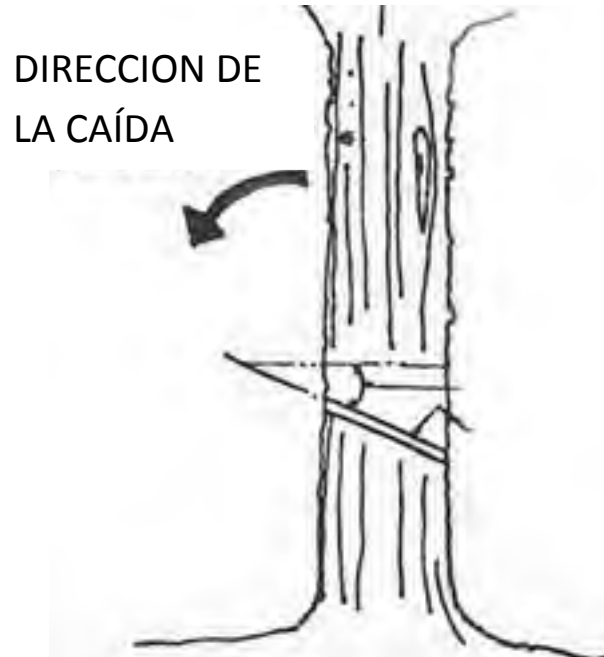
Figura 5. Inclinación de los barrenos. 20°Mínimo
