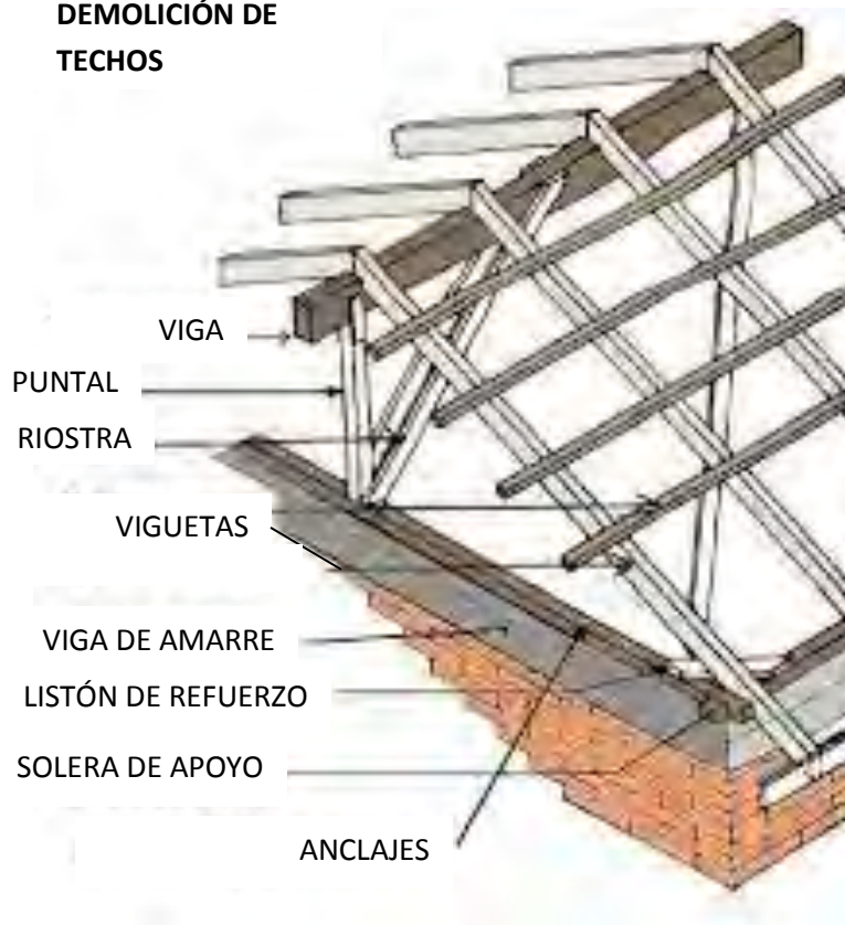
Figura 13. Demolición de techos
