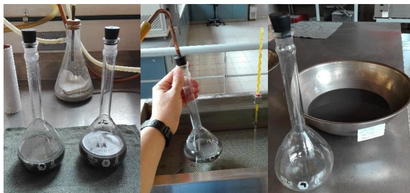
Figura 17: Ensaye densidad de sólidos.
