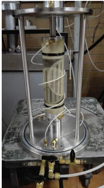
Figura 12: Montaje de probeta de suelo en cámara triaxial.
