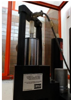
Figura 24: Sensor de desplazamiento, modelo E1000.
