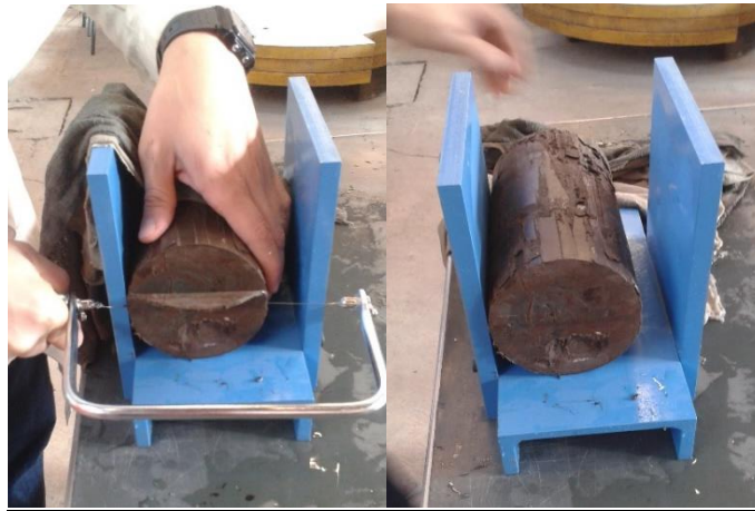
Figura 8: Careado de muestra de suelo.
