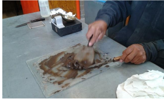
Figura 13: Remoldeo de material para el ensaye del límite líquido.
