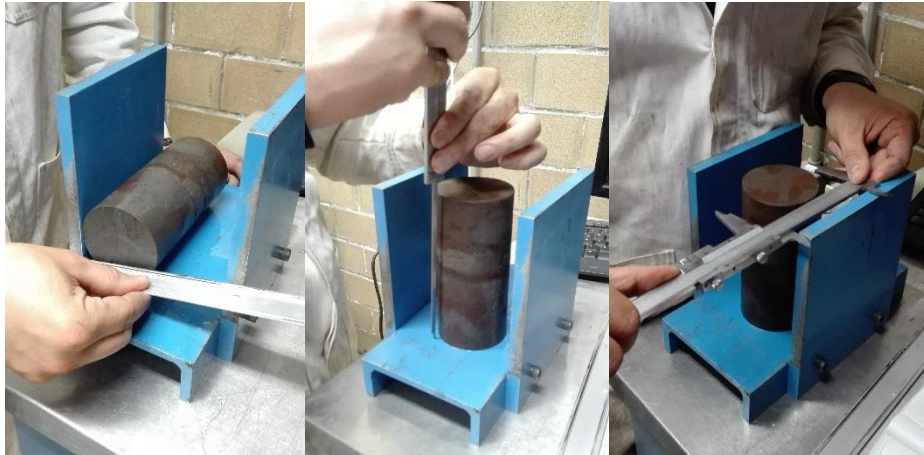
Figura 10: Careado y registro de dimensiones de muestra de suelo.
