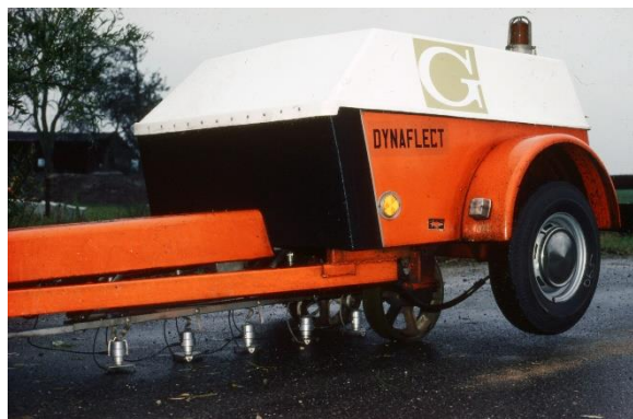
Figura 3: El sistema Dynaflect en posición operativa
