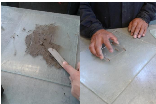
Figura 16: Ensayo límite plástico.
