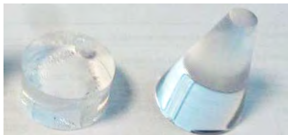
Figura 3.30. Plásticos centelladores utilizados NE 102
