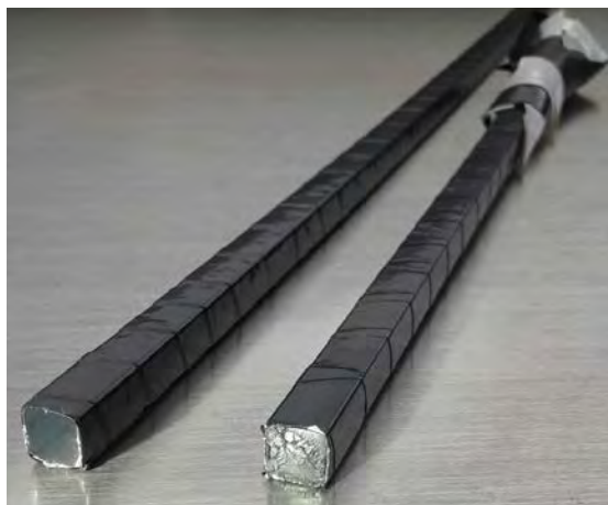
Figura 3.35. Acoplamiento de la guía de onda cuadrada con el plástico centellador
