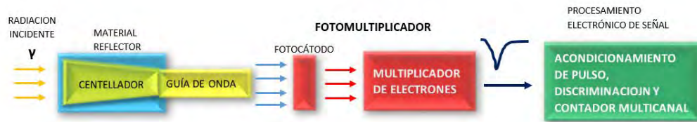
Figura 2.1. Sistema para detección
