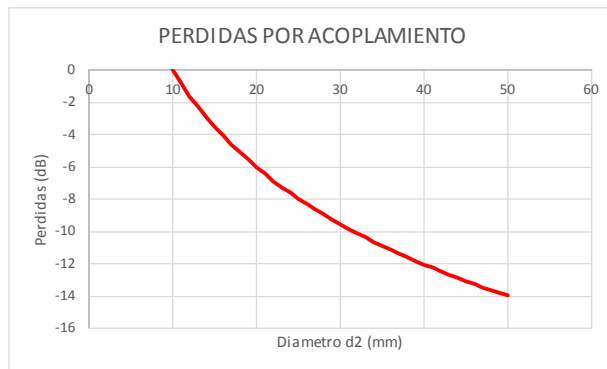
Figura 2.36. Pérdidas por acoplamiento entre el detector y la fibra
