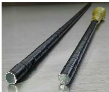
Figura 3.32. Acoplamiento de la guía de onda con el plástico centellador
