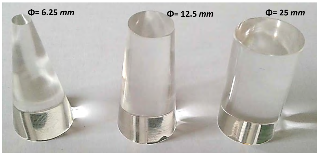
Figura 3.11. Tapers de acrílico para experimentación
