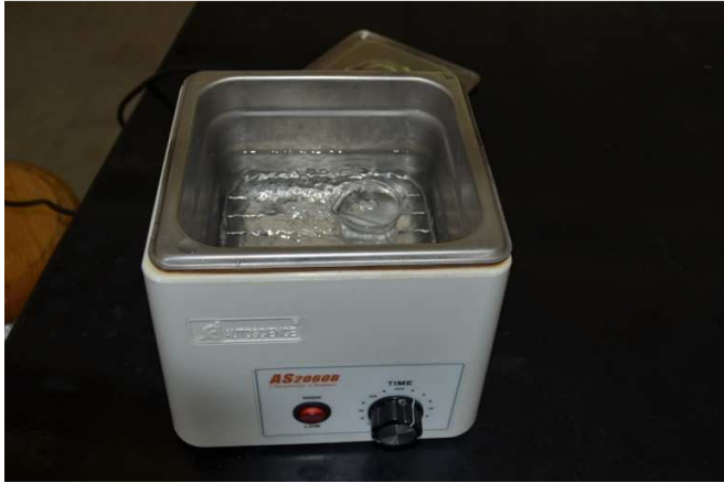
Figura 2.4 Sustrato en vaso de precipitado a baño ultrasónico.
