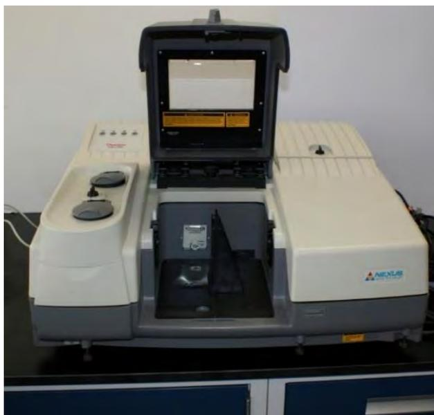
Figura 23. Espectrómetro FTIR Nicolet Nexus 470.
