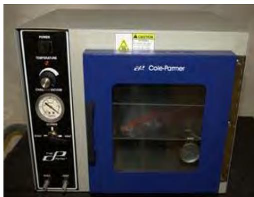
Figura 21. Horno con sistema de extracción de vacío Cole-Parmer.EW-05053-20
