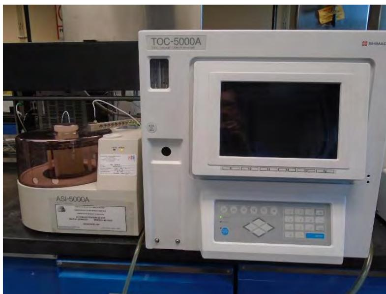
Figura 14. Equipo analizador de Carbono Orgánico Total Shimadzu TOC-5000A.
