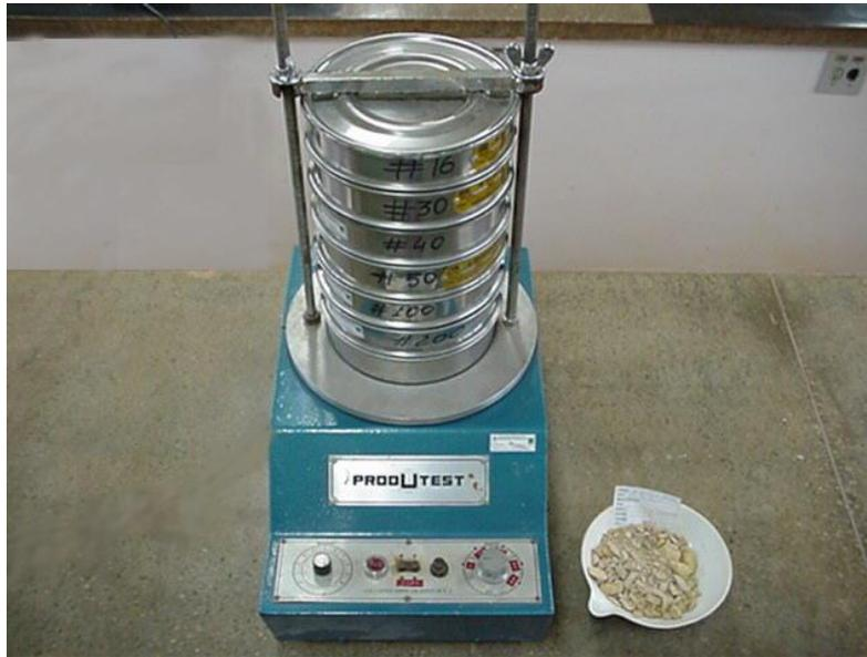
Figura 2.3- Máquina para clasificación granulométrica.
