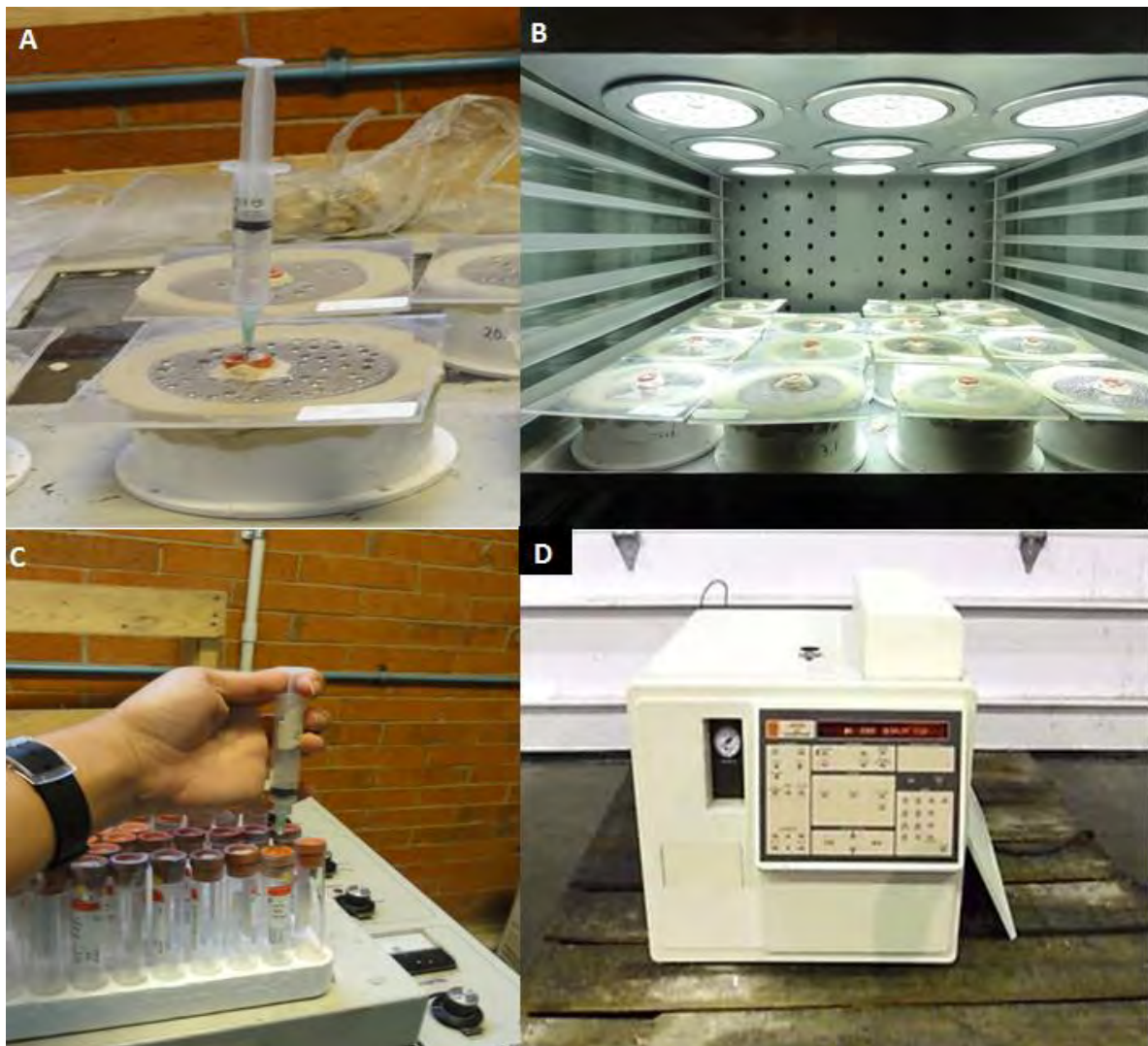
Figura III.2 Esquema del Ensayo de reducción de acetileno (ARA). (A) Inyección de 10 % de acetileno en las muestras selladas, (B) Muestras selladas e incubadas durante 72 horas en las condiciones de jardín común. (C) Muestra de gas extraído de las muestras selladas e incubadas es
