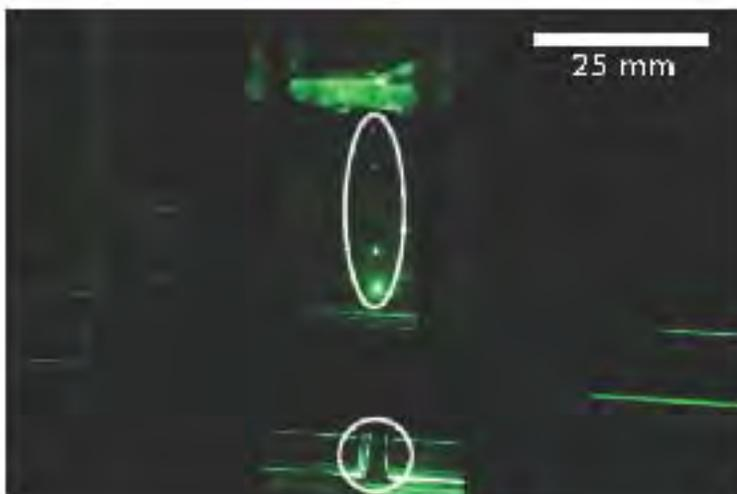
Figura 10: Fotografía de operación de la celda de atrapamiento. Las microgotas se generan continuamente por el cartucho de inyección (no mostrado). Varias microgotas (puntos brillantes en la elipse superior) descenden a través del haz levitador hacia el punto de atrapamiento de las pinzas ópticas (adentro del círculo inferior)
