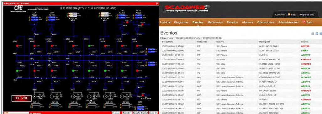
Figura 2.2. SCADAWeb como diagrama unifilar y secuencia de eventos
