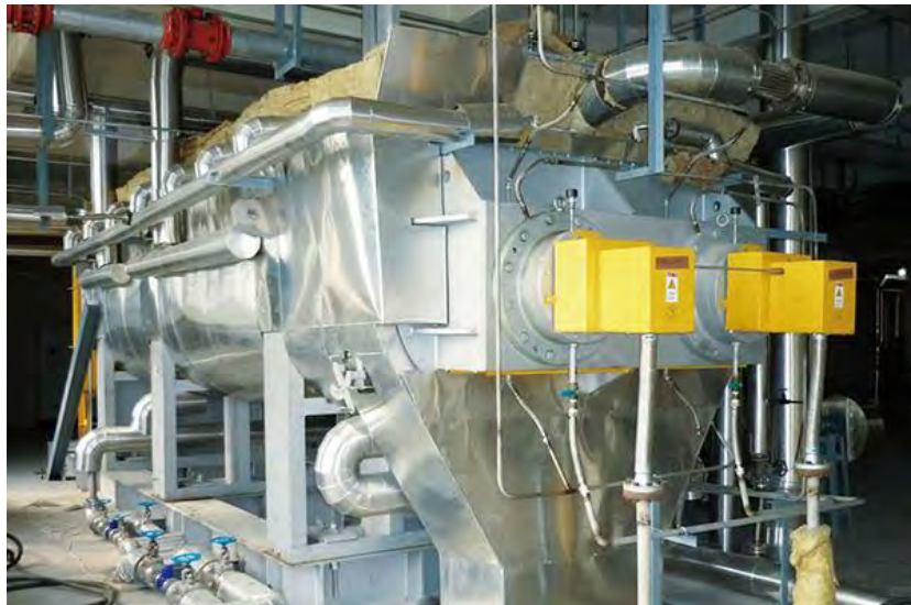
Ilustración 2.3 Secador indirecto. [Xian Feng, 2000]
