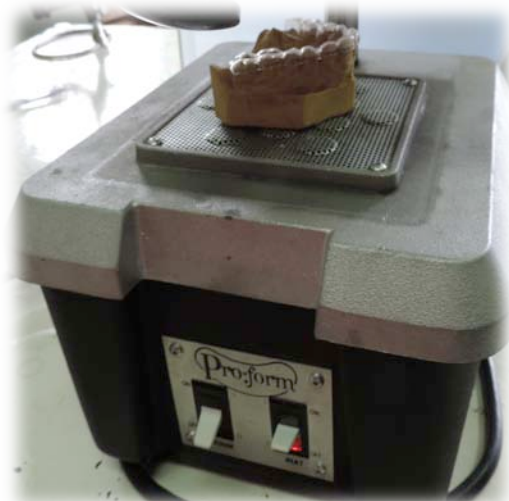
Fig. 22 y 23 colocación del acetato rígido en modelo por medio del Termoconformador Fuente directa
