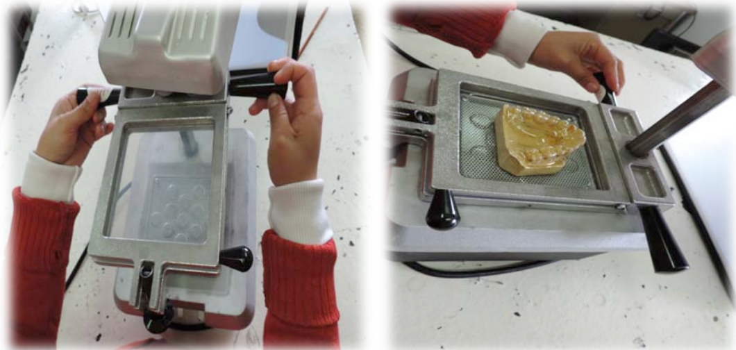
Fig. 17 y 18 Colocación del modelo en termoconformador antes y después de colocar el acetato blando Fuente directa
