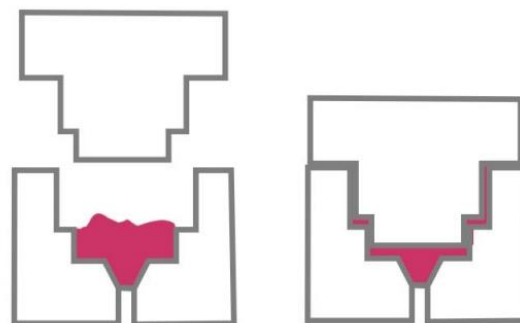
Fig. 15 Esquema que explica el “Moldeo por compresión”.
