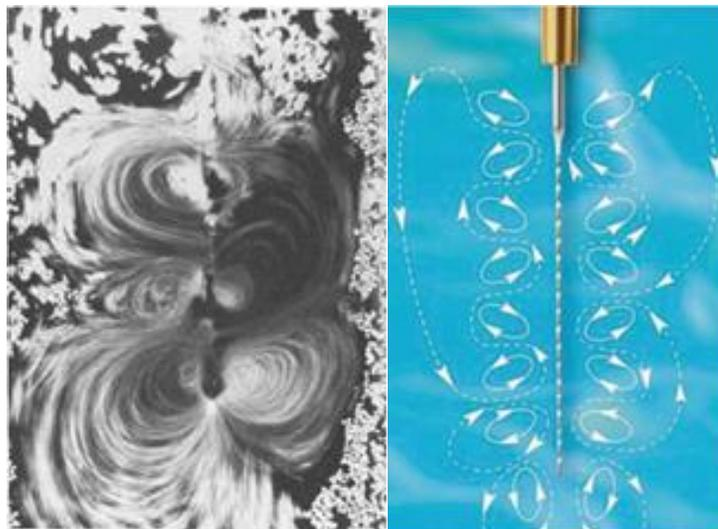
Fig.16. Microcorriente acústica alrededor de un inserto libre y un dibujo esquemático.<sup>8</sup>
