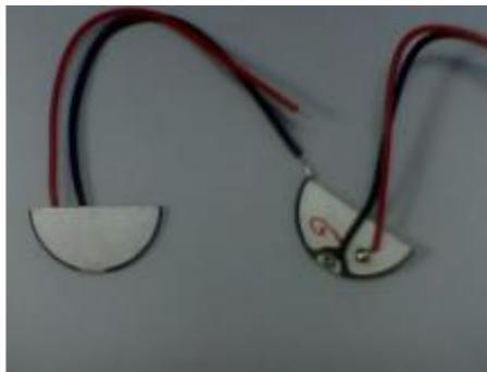
Fig.10. Discos de cerámica PZT 4 de un dispositivo piezoeléctrico. <sup>2</sup>
