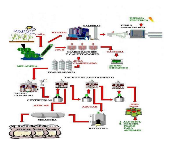
Figura 4. Proceso industrial para la obtención de azúcar de caña. 11
