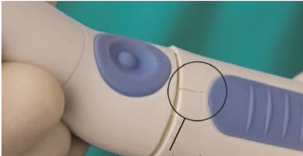
Fig. 29. Daño en el contra-ángulo de la pieza del sistema EndoActivator®. (Fuente: Ruddle, C. Rocker Arm Replacement. http://www.endoruddle.com/tc2pdfs/show/115/EAPART10_Color.pdf )
