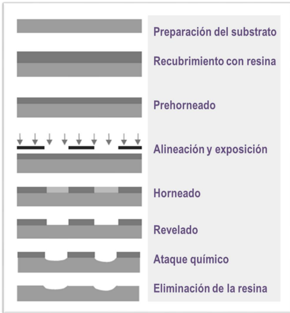
Figura 13. Pasos de un proceso fotolitográfico.
