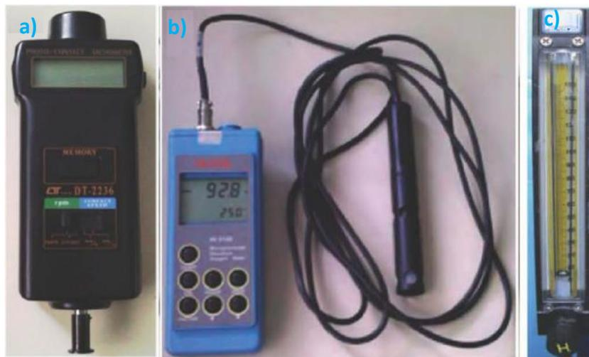
**Figura 2.3.** a) Tacómetro, b) Oxímetro, c) Flujómetro.
