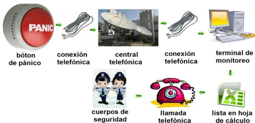
Figura 2.10 Sistema de Seguridad.
