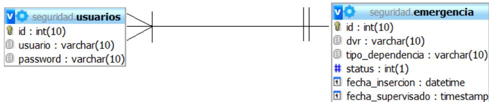
Figura 4.12 Diagrama entidad/relación operador del sistema – emergencia.
