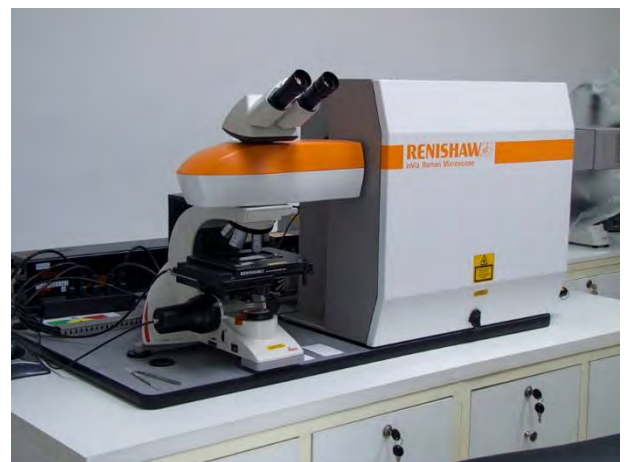
Fig.7: espectrómetro RAMAN utilizado en éste estudio.
