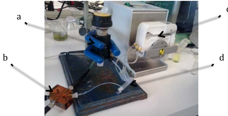
Figura 23. Acoplamiento del microchip (d) al sistema de propulsión (c), válvula de inyección (a) y a la celda de flujo (b) donde se realizó la detección.
