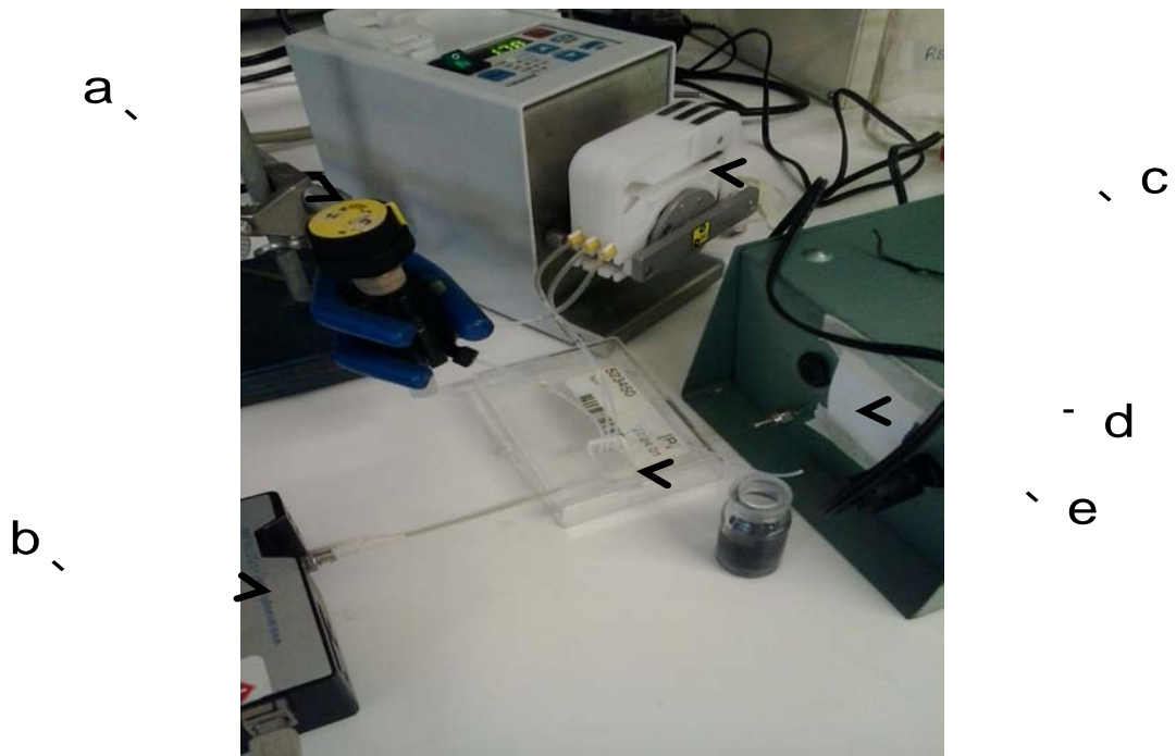
Figura 19. Sistema montado para la determinación de polifenoles totales. a) Válvula de inyección (sistema de inyección), b) Detector de luz, c) Bomba peristáltica (sistema de propulsión), d) Lámpara, e) Microchip.
