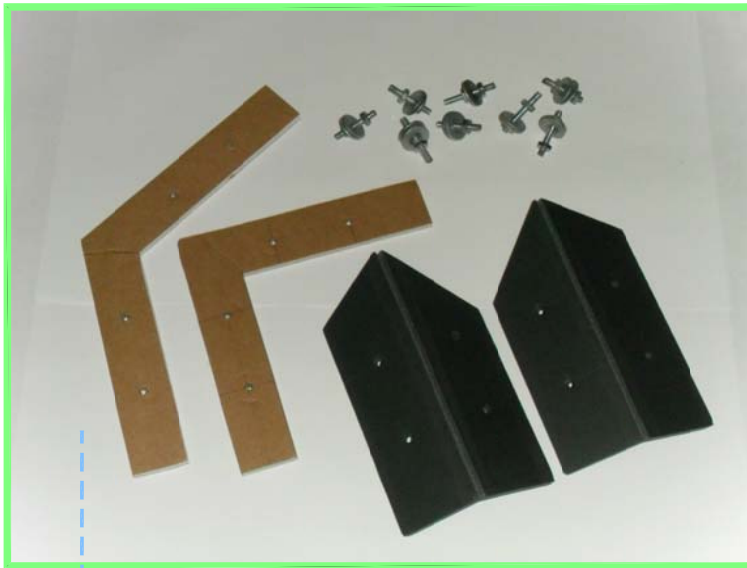
Elementos de nudo prototipo. Las puntas negras corresponden a las terminaciones de barras (4).
