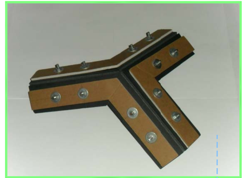
Nudo prototipo ensamblado. Los elementos café corresponden a las escuadras o acopladores (5).
