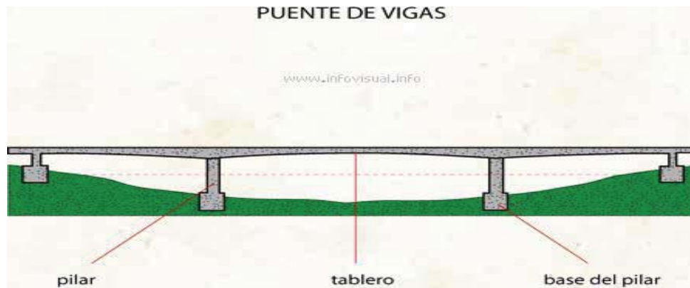
Imagen. 1.3. Puente de Vigas Rectas.
