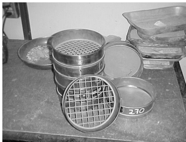
Imagen 1.2 Mallas para granulometría.
