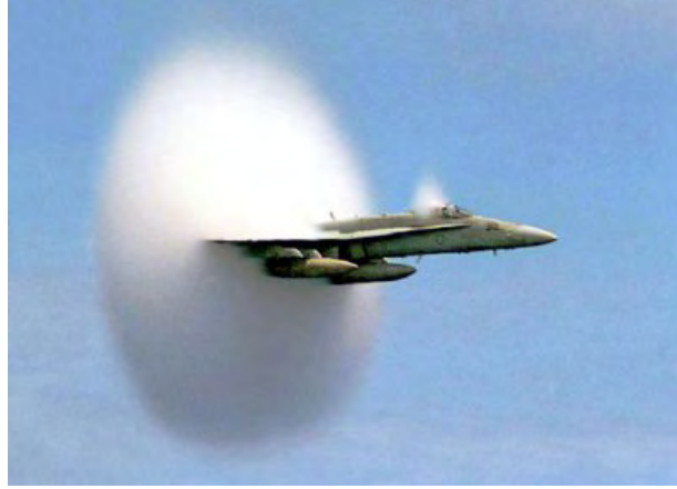
FIGURA 2.3: Cuando un jet viaja a la velocidad del sonido se crea una onda de choque que se puede visualizar como una fluctuación drástica en la presión del medio.
