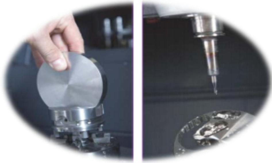
Figura 3: Bloque cromo-cobalto y detalle de fresado.
