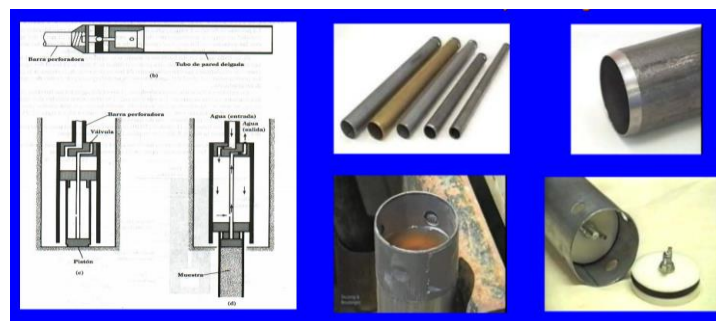
Figura 3.17 Toma de Muestras con tubo de pared delgada. (perforacionesgomez.com).
