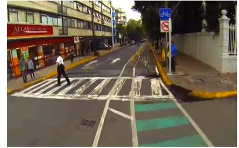
Figura 33. Der. Crucero debidamente señalado horizontal y verticalmente, indicando ciclo vía y no paso de motocicletas. (El ojo de las ciclo vías y más, canal de YouTube, publicado el 26/01/2015)
