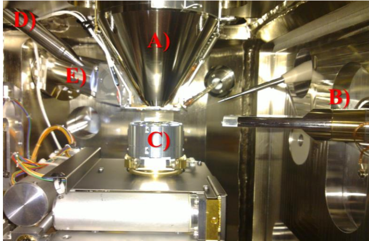
Fig. 16. Cámara interna del SEM JEOL-JIB-4500.
