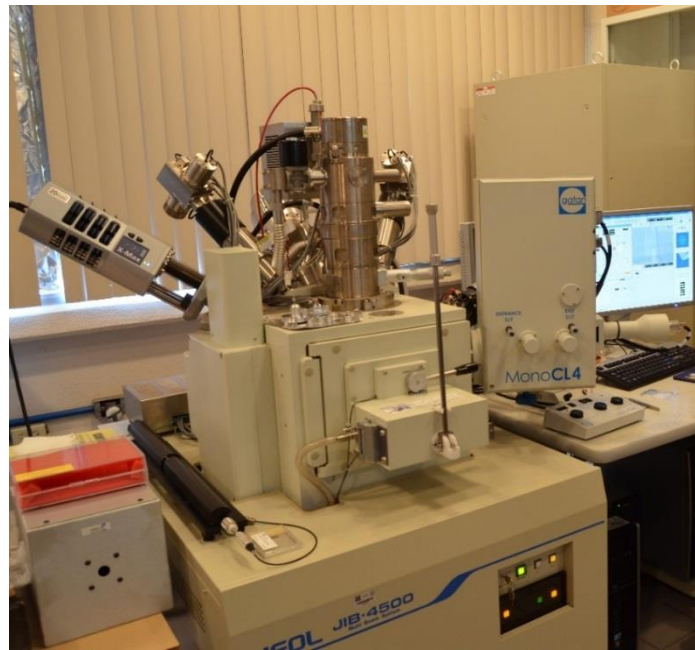
Fig. 15. Microscopio electrónico de barrido JEOL-JIB-4500 y su sistema de catodoluminiscencia Gatan-MonoCL4.
