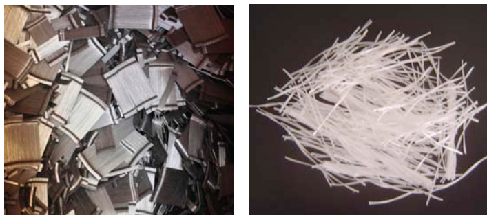
Figura 2.3 Fibras Dramix y TufStrand SF
