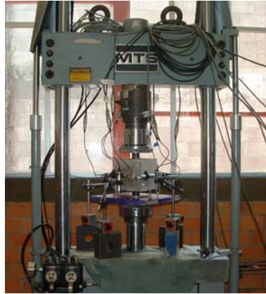
Figura 3.2 Equipo MTS y montaje de ensayo MDPT
