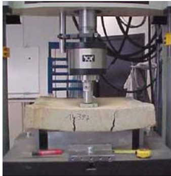
Figura 1.6 Configuración del panel cuadrado (EFNARC, 1996)
