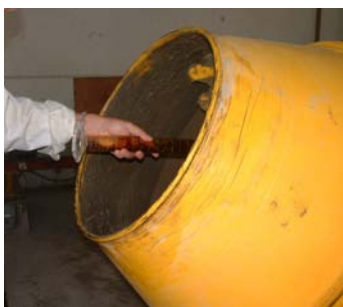
Figura 2.6 Incorporación de aditivo Pozzolith 322 N
