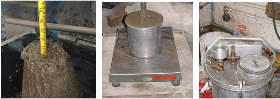
Figura 2.8 Prueba de revenimiento, peso unitario y contenido de aire
