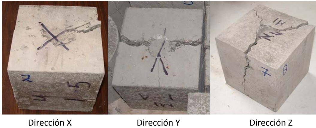
Figura 3.3 Modo de falla ensayo MDPT
