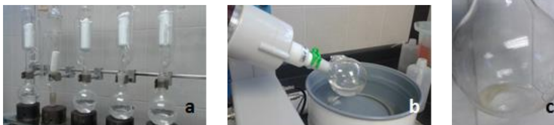
Figura 8. Extracción de la grasa por el método Soxhlet; (b) Muestra de hexano con grasa en el rotavapor y (c) muestra de grasa después de extraer el hexano
