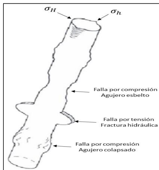
Figura 4.22 Fallas por compresión y tensión.
