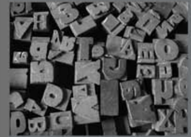
fig.6 Tipos móviles de metal (con los que se hacen las formas tipográficas)
