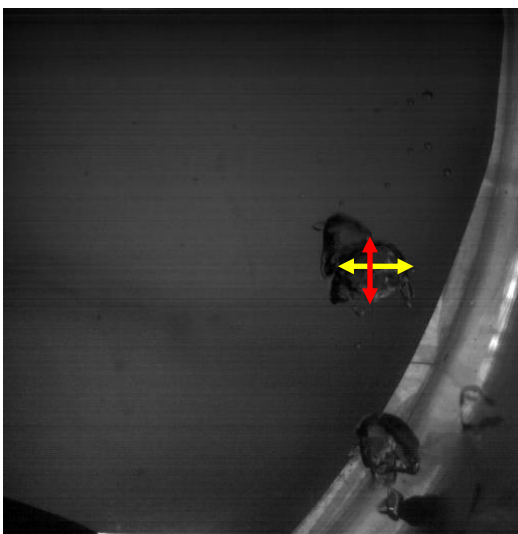
Figura 4.11. Determinación del diámetro promedio de burbuja para un flujo de 2 LPM.
