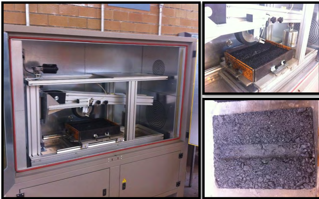
Figura A13. Susceptibilidad a la deformación por rodadura de una mezcla asfáltica.
