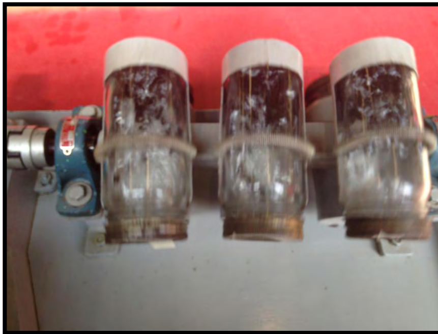
Figura A19. Muestras sometidas a proceso de agitación de acuerdo a la norma M-MMP-4-04-009/03
