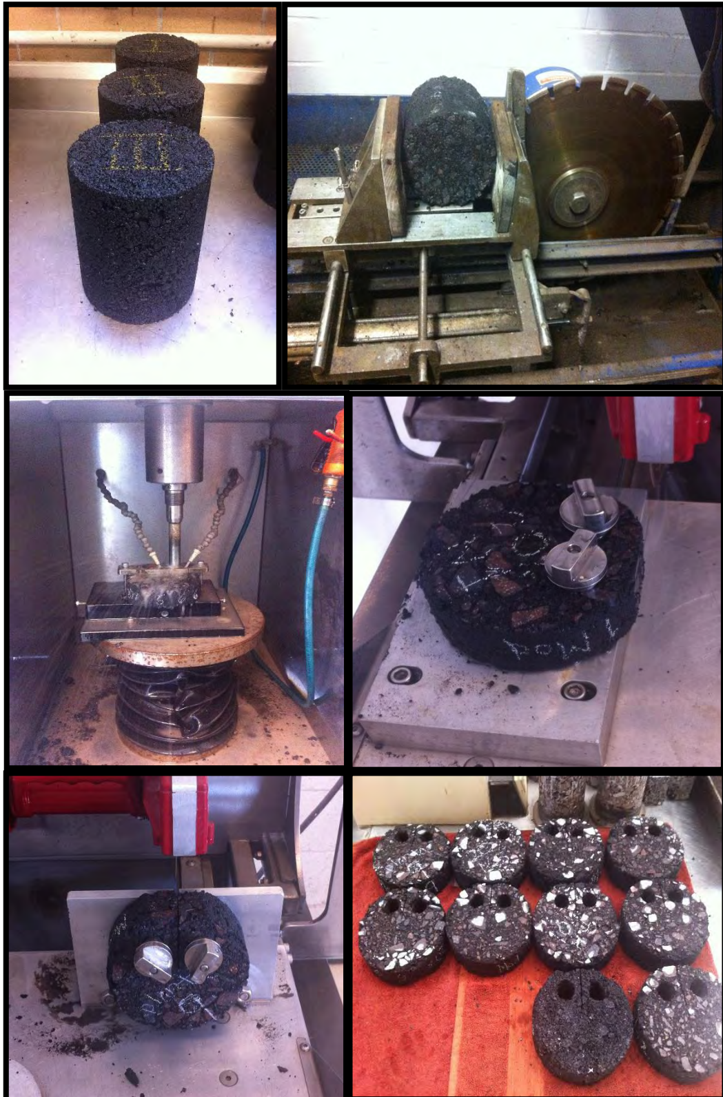
Figura 3.18 Elaboración de la probeta de fractura de acuerdo a la norma ASTM D 7313-07
