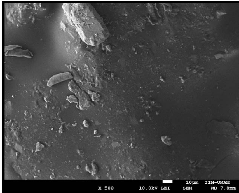
Figura 3.5 Imagen microscópica del asfalto ahulado, (escala 10 µm).
