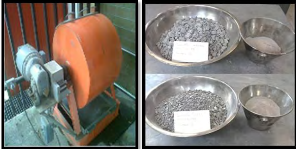
Figura A6. Prueba de desgaste los ángeles
