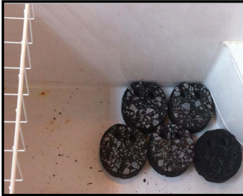
Figura 3.19 Acondicionamiento de probetas de acuerdo a la norma ASTM D6373
