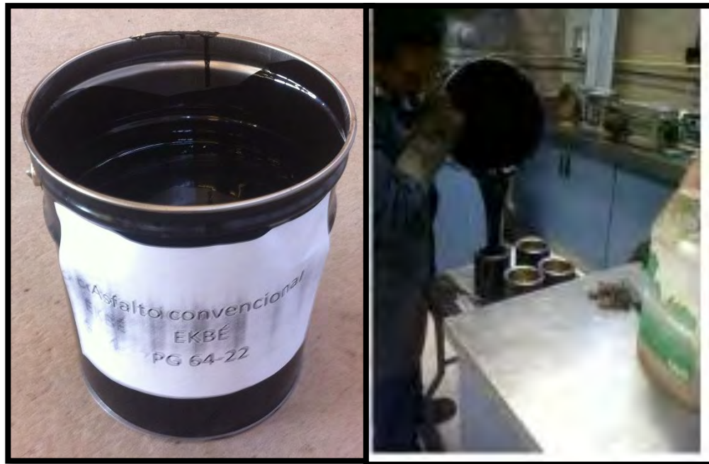
Figura 3.2. Asfalto EKBÉ PG-64-22.
