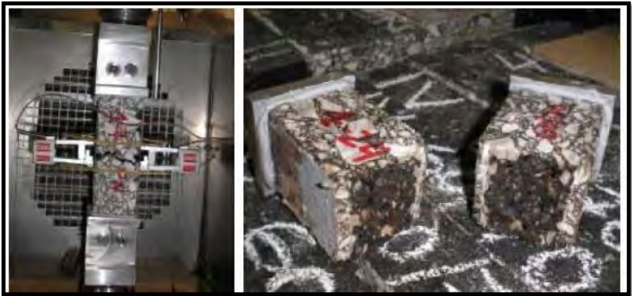
Figura 2.16. Montaje del ensayo BTB y superficie de fractura de la probeta ensayada [35].
