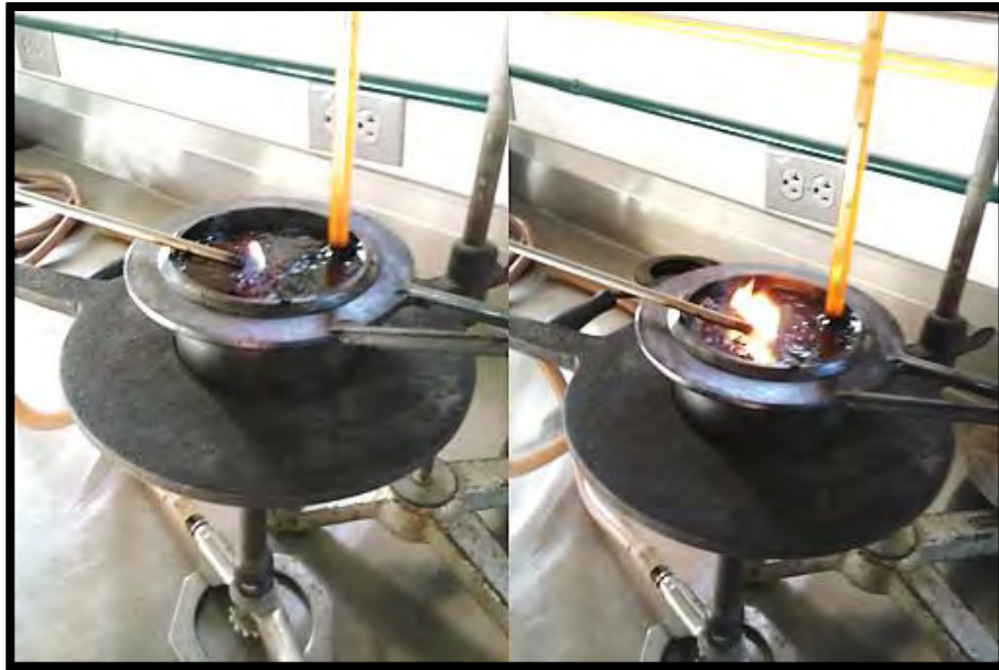
Figura A10. Punto de inflamación Cleveland
