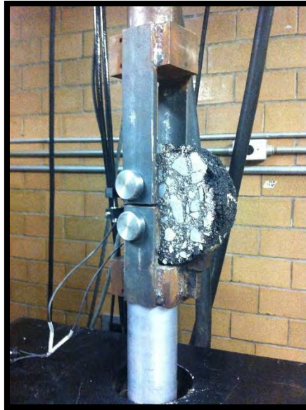
Figura 3.20 Probeta instalada con los accesorios de carga
