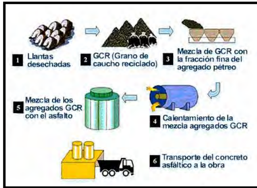
Figura 2.5 Proceso de adición de polvo NFU al asfalto por vía seca [35].
