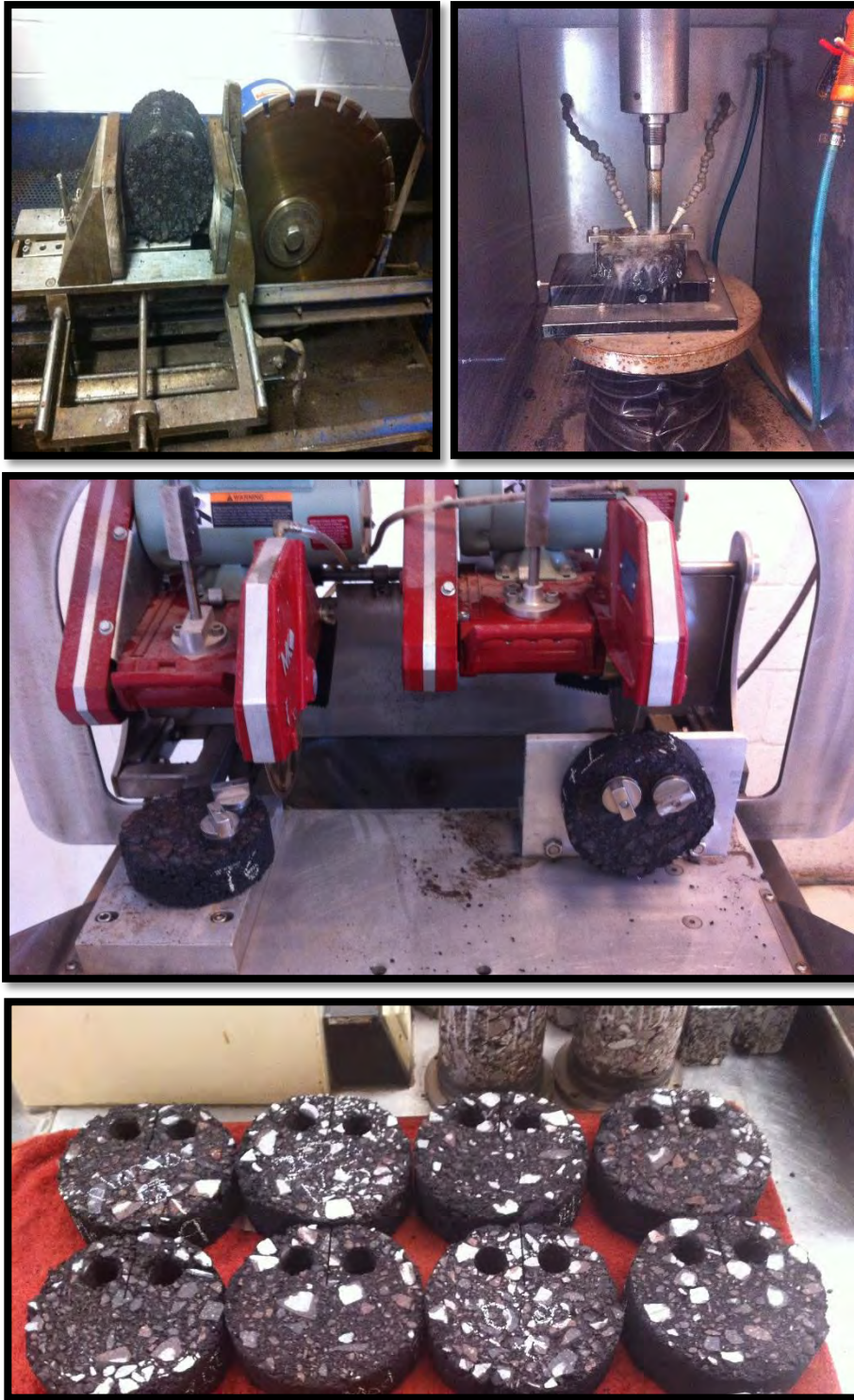
Figura A16. Corte realizados en cada uno de los especímenes para obtener la geometría requerida en la prueba de fractura.
