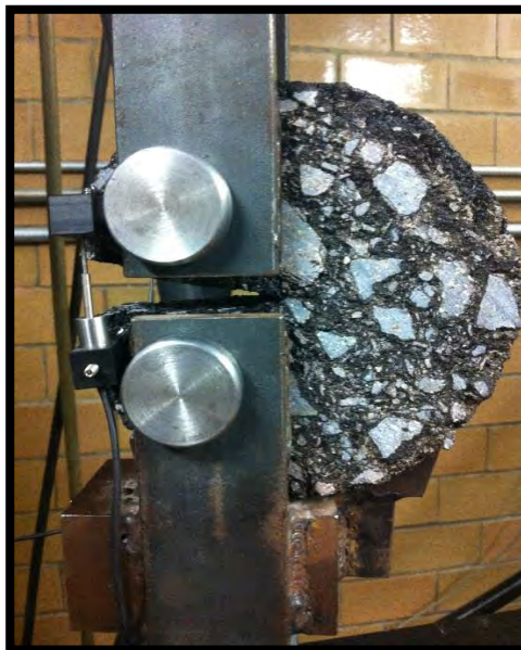
Figura 3.21 Probeta llevada a la falla a una velocidad de 0.017 mm/s.
