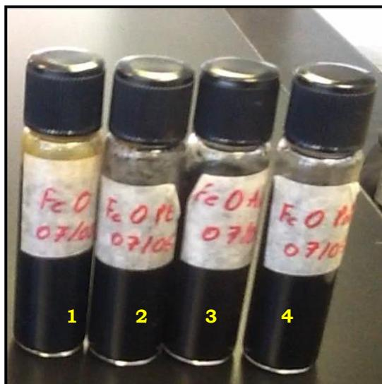
Figura 4.1.2 Muestras sintetizadas por el primer método con Ácido Oleico y Oleilamina.
