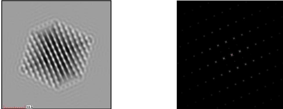
Figura 4.3.39 Imagen simulada de HRTEM y su respectiva FFT de la fase magnetita orientada en el eje de zona [211].
