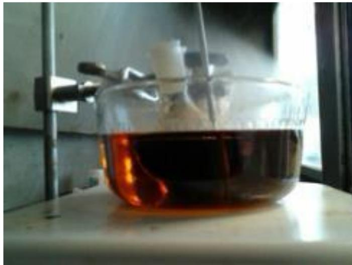
**Figura 4.1.3. Muestras sintetizadas por el método con Difenil Éter y Oleilamina.**
