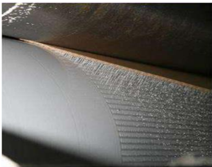
Figura 3.23: Aplicación del adhesivo sobre la cresta inferior del single face
