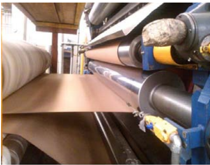
Figura 3.22: Enhebrado del single face entre el rodillo de ajuste y el de contacto
