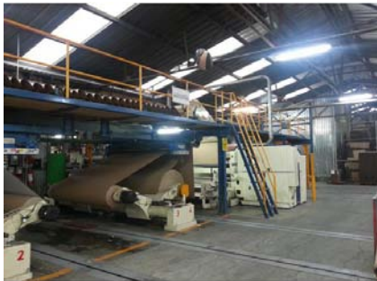
Figura 3.14: Perspectiva del portarrollos doble para la formación de la onda
