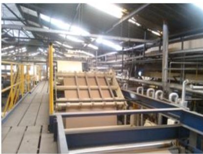
Figura 3.19: Subida del corrugado de una sola cara hacia el puente de almacenamiento
