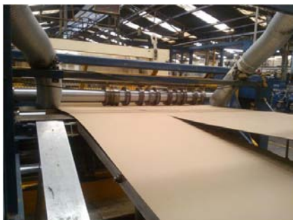
Figura 3.26: División de los pliegos con su correspondiente hendido
