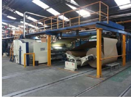
Figura 3.13: Perspectiva del portarrollos doble para el liner
