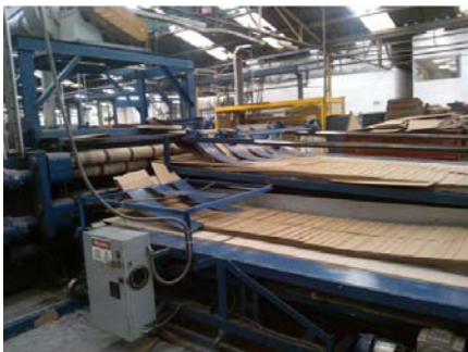
Figura 3.28: Salida de los pliegos de la cortadora rotativa transversal hacia las mesas de recepción
