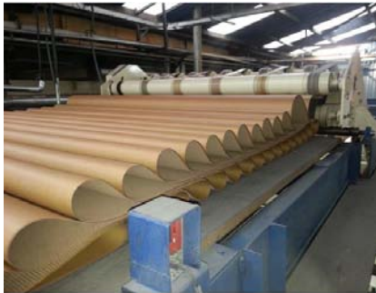
Figura 3.20: Puente de almacenamiento
