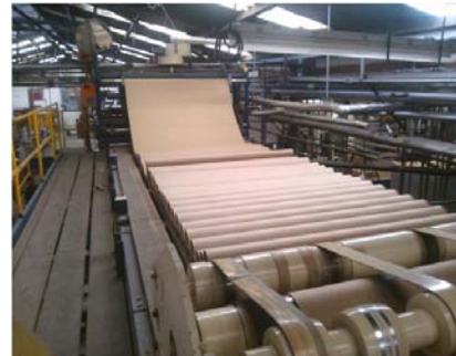
Figura 3.21: Single face en dirección al doble engomador
