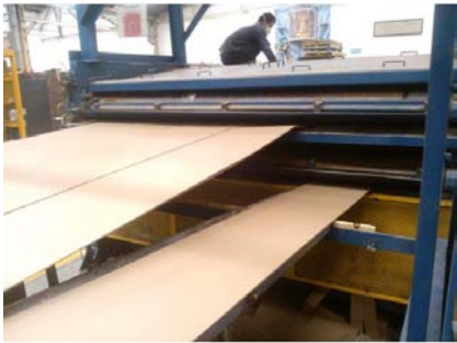
Figura 3.27: Pliegos entrando a la cortadora rotativa transversal
