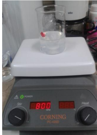
Imagen 2.4. Parrilla de agitación magnética Corning PC-4200, trabajando a 800 RPM.
