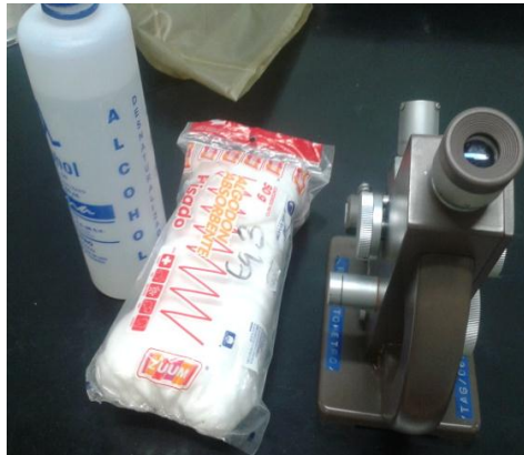
Imagen 2.8. Refractómetro ATAGO, JAPAN, No 42993, usado para la obtención del índice de refracción
