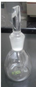
Imagen 2.7. Picnómetro BRAND de 25 mL, usado para obtener la densidad de la solución.
