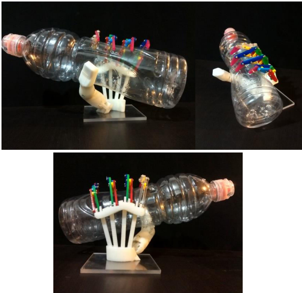
Figura 5.18. Diámetro grande. La estructura sostiene una botella de agua, obsérvese que es completamente sostenida por la estructura y que se encuentra orientada de forma próxima a como lo realiza la mano humana. Además, nótese que el pulgar está completamente opuesto a los dedos.
