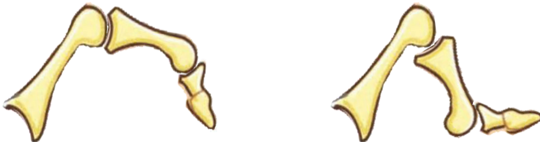
Figuras 2.5. a) A la izquierda se muestra la configuración codo arriba del dedo. Esta configuración permite que las falanges no interfieran en el campo de sujeción del dedo. b) A la derecha se muestra la configuración codo abajo. En esta configuración el campo de sujeción se ve comprometido además de que ésta denotaría un dedo roto, enfermo o con malformación.
