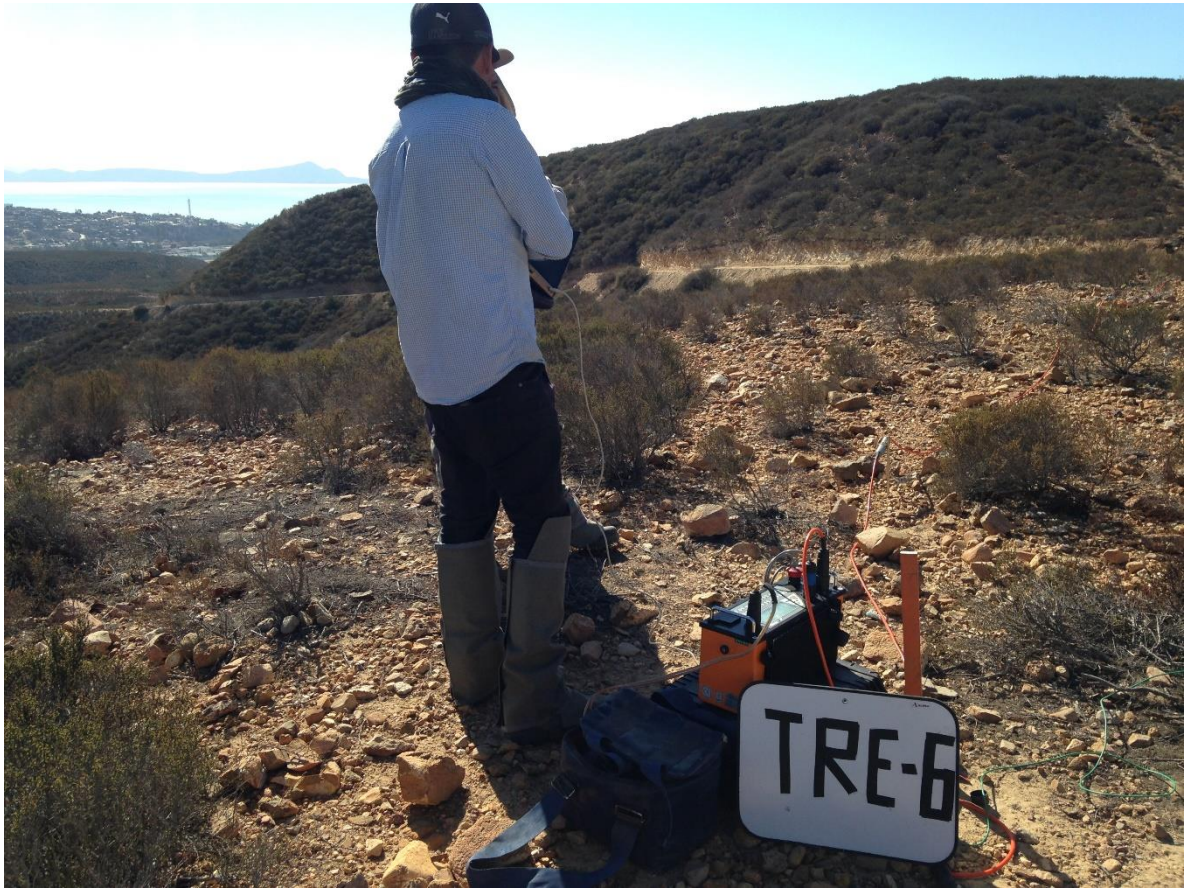
Fig. 3-7 Equipo de Tomografía de Resistividad Eléctrica en el cadenamiento 600+000
