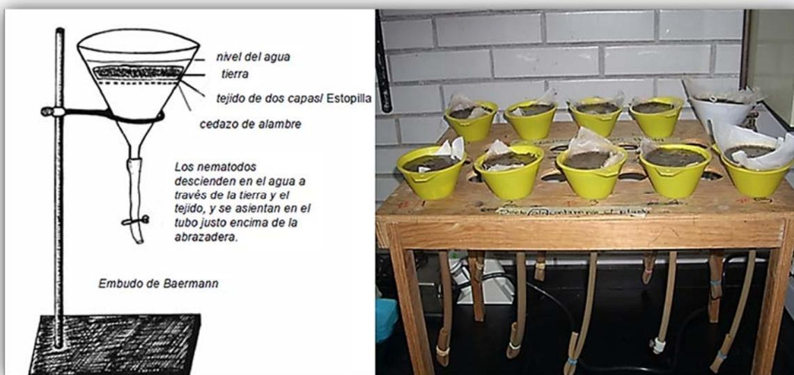
**Fig. 11.** Técnica del embudo de Baermann utilizada para la extracción de nemátodos.
