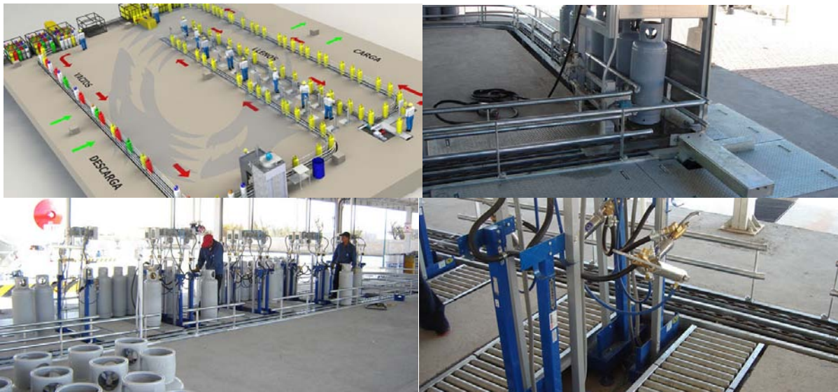
Figura6. Imágenes ilustrativas sobre la automatización en el muelle de llenado de cilindros portátiles (Fuente: portal de internet Industrial Ochoa , únicamente para fines de investigación).
