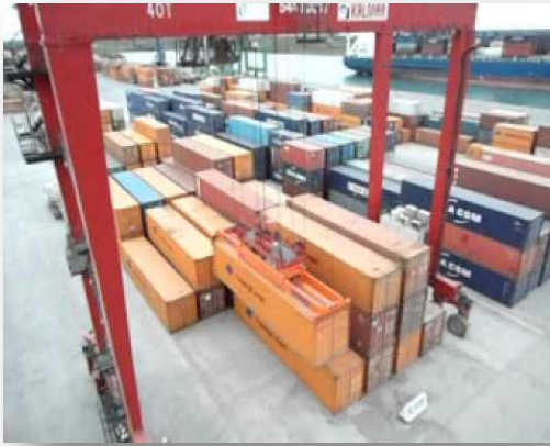
Grúa de marco/ RTG
