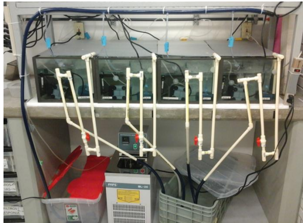
Figura 4. Sistema de recirculación de agua y enfriamiento. En la parte superior se muestran los tanques experimentales. Fotografía Isabel Rosas.
