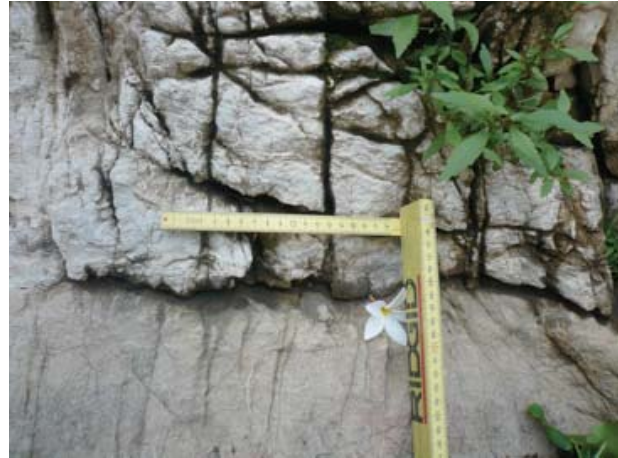
Fotografía 3. Detalle del afloramiento de calizas donde se colectaron datos de fracturamiento, nótese que la apertura de las fracturas, en algunos casos llega hasta el centímetro.
