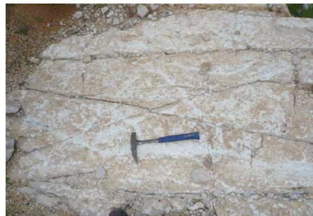
Fotografía 8. Par conjugado de fracturas en el afloramiento Maseca. Se trata de dos planos verticales uno en dirección 065^\circ y otra 220^\circ .
