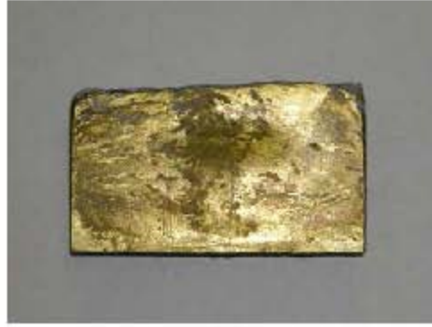
Figura 4.1: Lingote de la aleación Cu-Al11.2%wt.-Be0.6%wt obtenido por fundición
