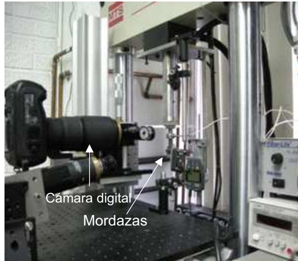
Figura 4.18: Imagen del experimento para los estudios de micromecánica por correlación de imágenes digitales.
