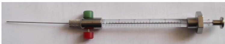
Figura 6. Jeringa especial para gas licuado, soporta hasta 250 psi [12]
