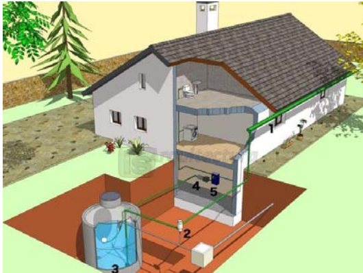
Ilustración 7 Ejemplo de los componentes de un SCALL ( http://perspectivasesia.blogspot.mx/2008/04/captacion-de-agua-pluvial.html )
