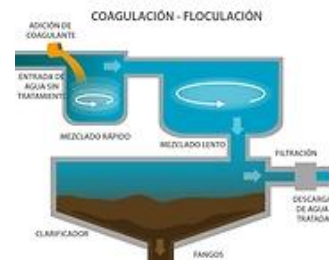
Ilustración 8: Ejemplo de coagulación-floculación. ( https://www.koshland-science-museum.org/water/html/es/Treatment/Coagulation-Flocculation.html , abril 2011)
