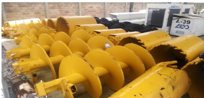
Figuras 39 y 40 . Herramienta de perforación. Pilas en Arenas
