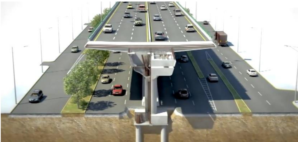
Figura 8. Corte de estructura general AUN y AUS.
