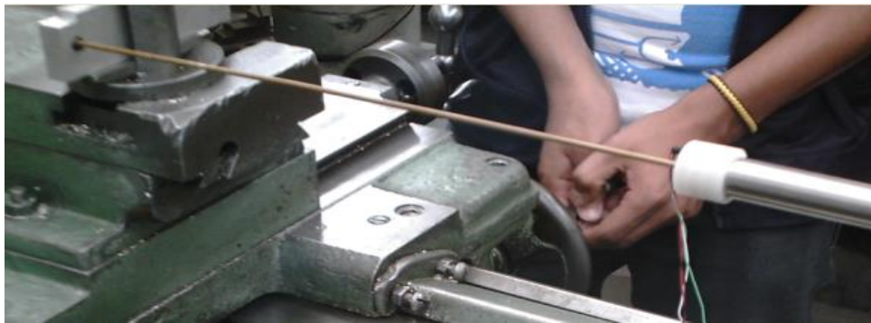
Fig. 3.11 El soporte móvil del porta-herramientas mueve al LVDT del torno.
