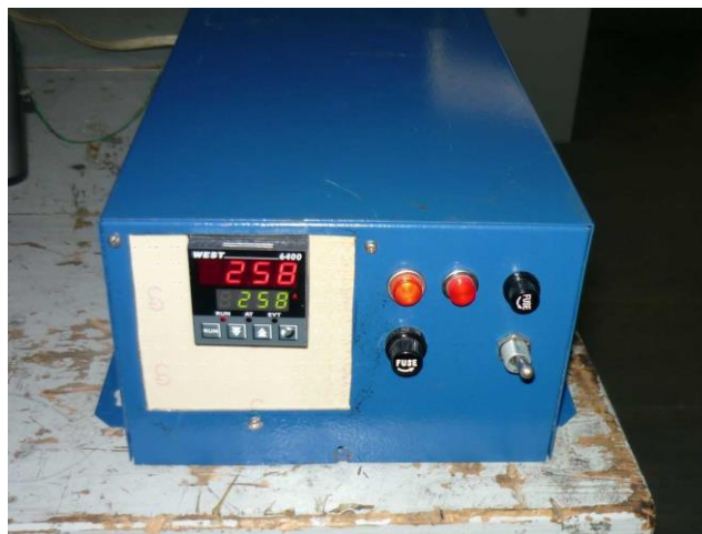
Fig. 3.35 El controlador empotrado en una carcasa que contiene el relevador.
