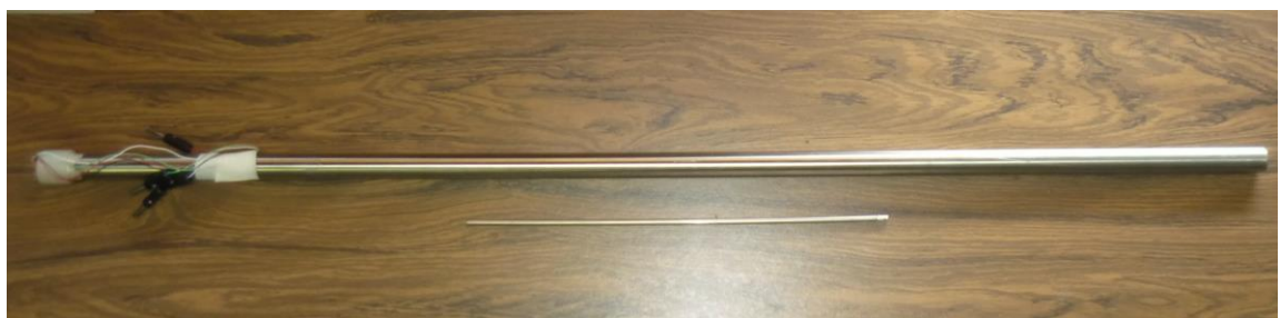
Fig. 3.3 LVDT de 90 cm con sus cables y su núcleo.
