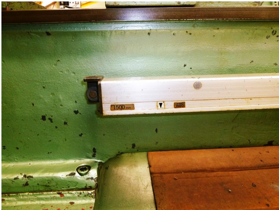
Fig. 3.13 La regleta del torno que se usó para la calibración del LVDT.
